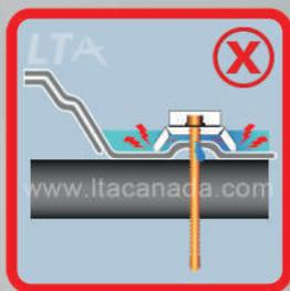
Por ninguna razón se debe instalar el tornillo sobre el valle de la teja, de lo contrario se producirán filtraciones, estancamientos de agua y polvo. El tornillo se oxidará y manchará la teja.
